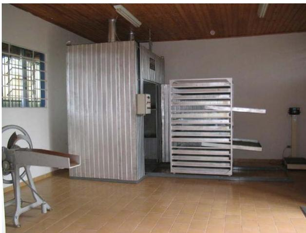
*Figura 13 – Secador com bandejas carregadas com plantas a serem secadas.*
