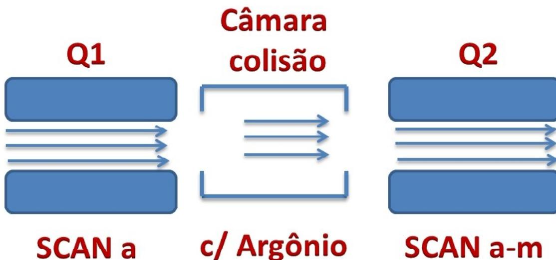
**FIGURA 15** | Representação esquemática do modo de aquisição de varredura por perda de neutros constante em um equipamento de triplo quadrupolo.
