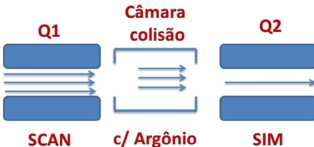
**FIGURA 14** | Representação esquemática do modo de aquisição de varredura de íons precursores em um equipamento de triplo quadrupolo.
