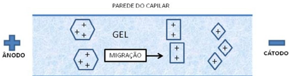
**FIGURA 7** | Representação da eletroforese capilar em gel no interior do capilar.
