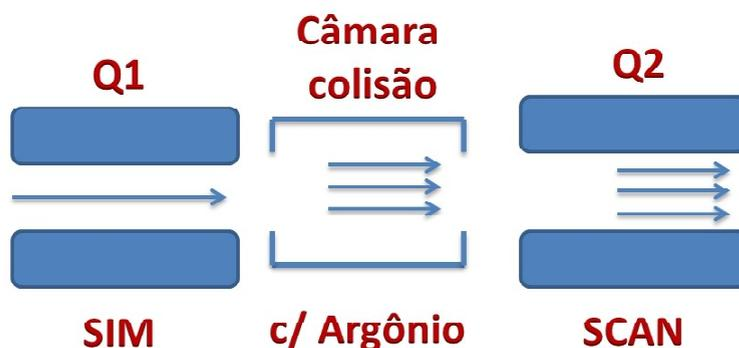
**FIGURA 12** | Representação esquemática do modo de aquisição de varredura de íons produto em um equipamento de tripo quadrupolo.
