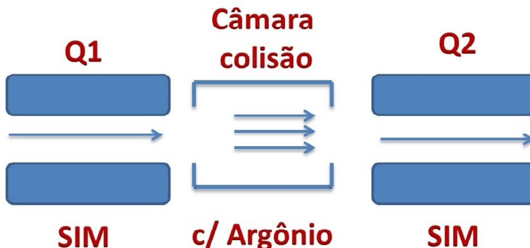
**FIGURA 13** | Representação esquemática do modo de aquisição de monitoramento de reação selecionada em um equipamento de triplo quadrupolo.
